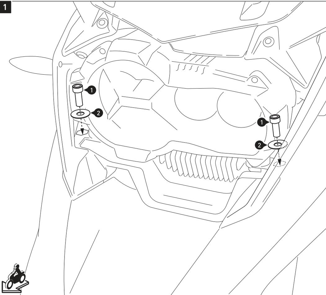
Setzen Sie die Schrauben (1) in die gezeigten Öffnungen des Fahrzeugs ein.
