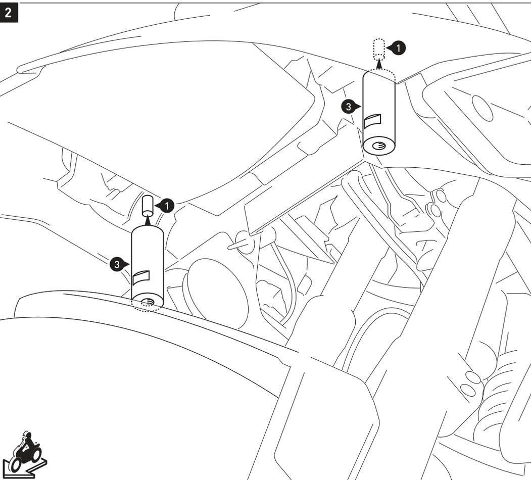
Verschrauben Sie die Gewindebuchsen (3) mit den Schrauben (1), wie in der Zeichnung gezeigt.
