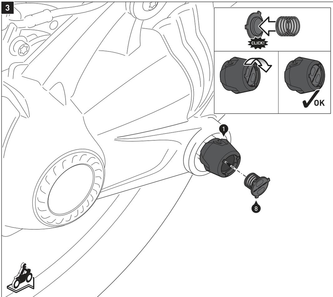
Setzen Sie die Abdeckkappe (8) in die Öffnung des montierten Sturzpad (5) ein und drehen Sie dieses bis in die Endposition.
