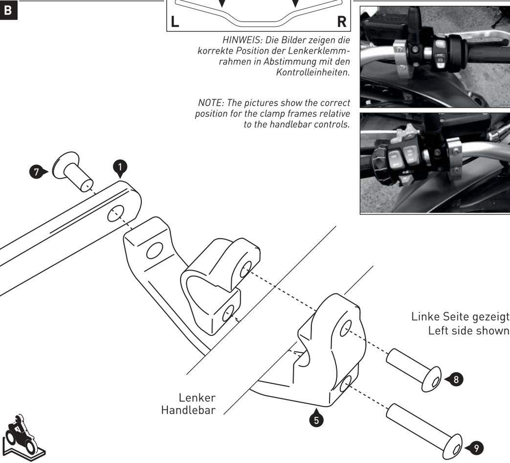
**HINWEIS:** Die Montage an den Anbaupunkten B ist linksseitig dargestellt. Wiederholen Sie die Montage mit den entsprechenden Teilen auf der rechten Lenkerseite analog zur linken Lenkerseite.
