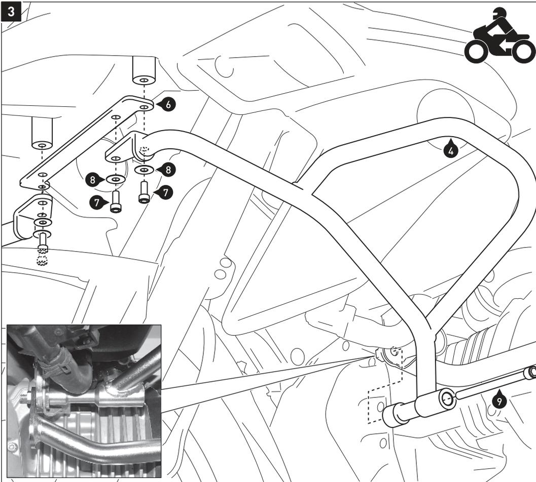
**HINWEIS:** Die Montage ist linksseitig dargestellt. Wiederholen Sie die Montage mit den entsprechenden Teilen auf der rechten Fahrzeugseite analog zur linken Fahrzeugseite.
