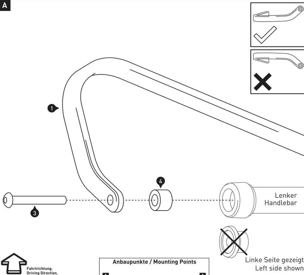
**HINWEIS:** Die Montage an den Anbaupunkten A ist linksseitig dargestellt. Wiederholen Sie die Montage mit den entsprechenden Teilen auf der rechten Lenkerseite analog zur linken Lenkerseite.
