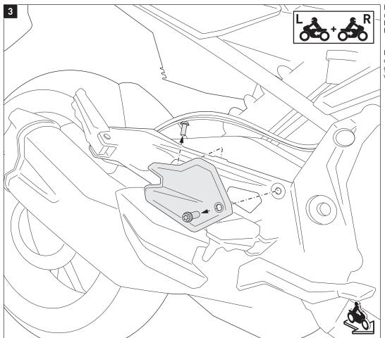
Lösen Sie die gezeigten Schrauben und den Kabelclip und entfernen Sie beidseitig die Fersenschützer vom Fahrzeug.
