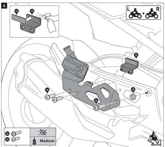
Reinigen Sie die Oberfläche der Konterbleche (12) gründlich von Fett- und Schmutzrückständen. Kleben Sie die Schonstreifen (13) auf, wie in der Detailzeichnung dargestellt.
