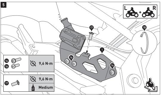
Verschrauben Sie die Anbaubleche (1) mit den Schrauben (17) am Fahrzeug.
