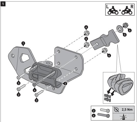
Montieren Sie die gezeigten Teile an den Anbaublechen (1) (linkes Anbaublech gezeigt).
