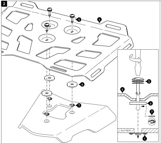
Setzen Sie die QUICK-LOCK Schnellverschlüsse (5) in die Öffnungen der Gepäckbrücken-Erweiterung (4) ein. Sichern Sie die QUICK-LOCK Schnellverschlüsse (5) mit den Sicherungsringen (7), wie in der Detailzeichnung gezeigt.
