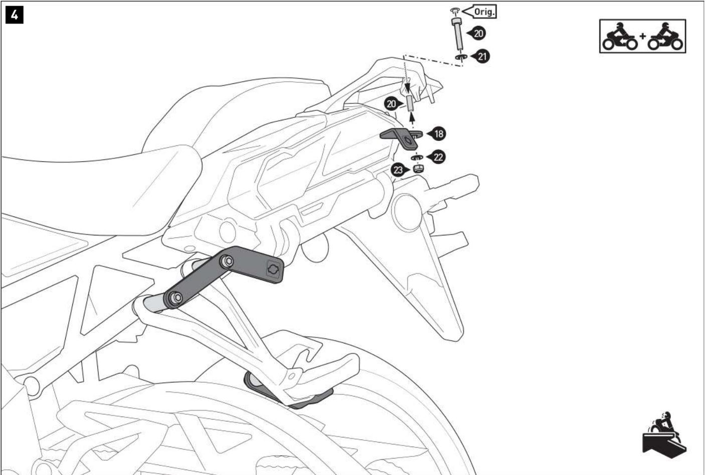
Verschrauben Sie die Schrauben (20) **beidseitig** am Gepäckträger. Achten Sie darauf, die Schrauben (20) bis zum letzten Gewindegang zu verschrauben.
