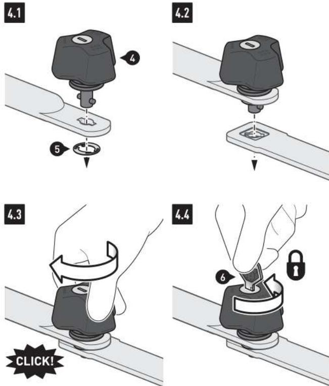
**Diebstahlsicherung für PRO Seitenträger montieren**
