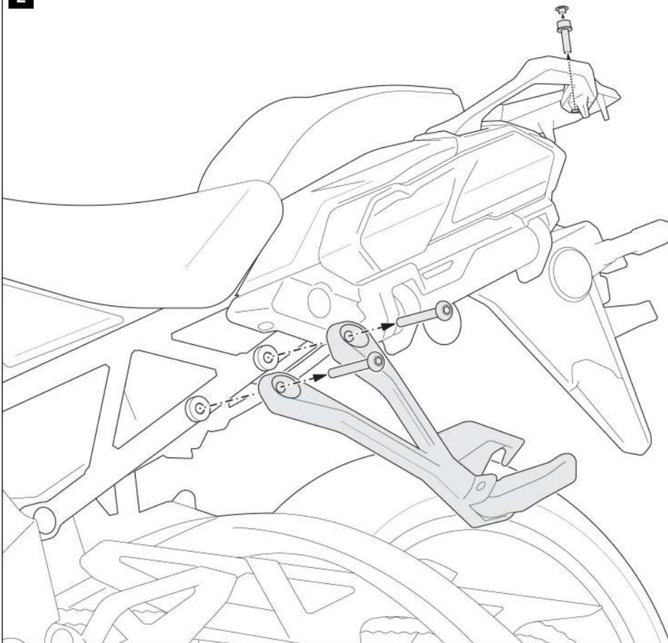
Entfernen Sie **beidseitig** die gezeigten Schrauben und die Soziusfußrastenhalter vom Fahrzeug.
