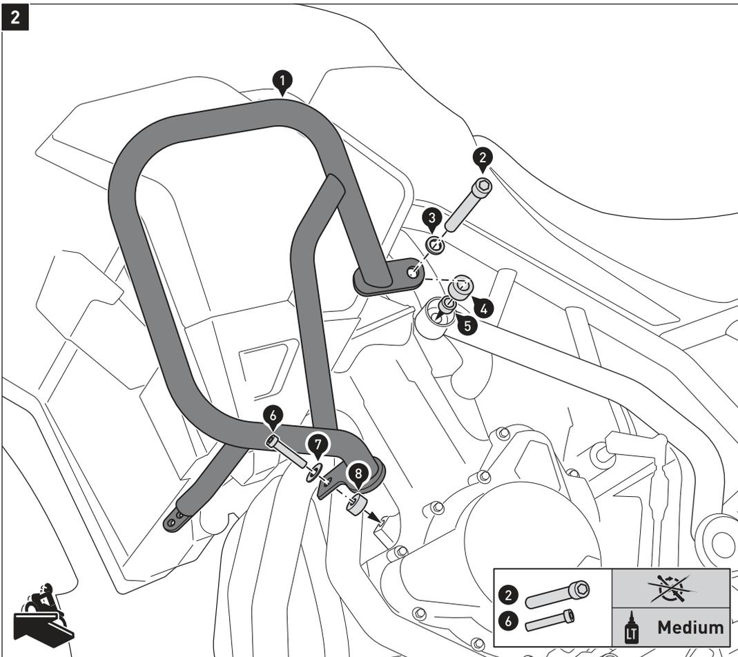
Verschrauben Sie anschließend den Sturzbügel (1) am Fahrzeug, wie in der Zeichnung gezeigt.
