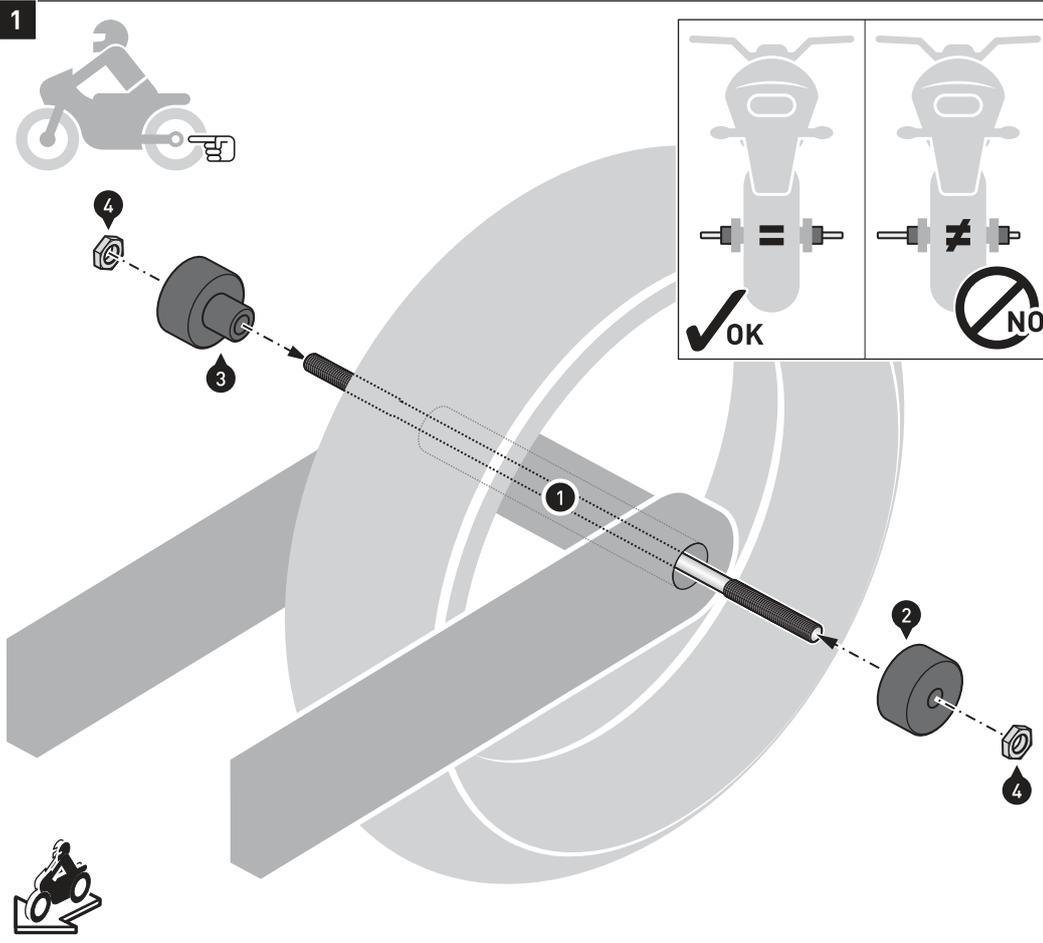
Führen Sie die Gewindestange (1) durch die **hintere** Achsaufnahme Ihres Fahrzeugs.
