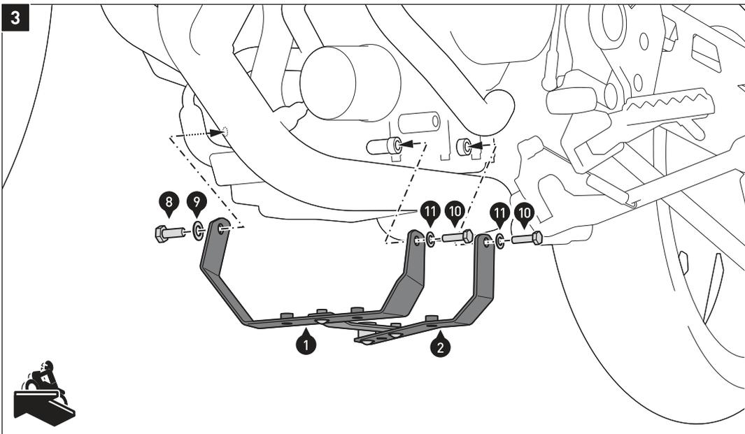
Verschrauben Sie die Teile am Fahrzeug.
