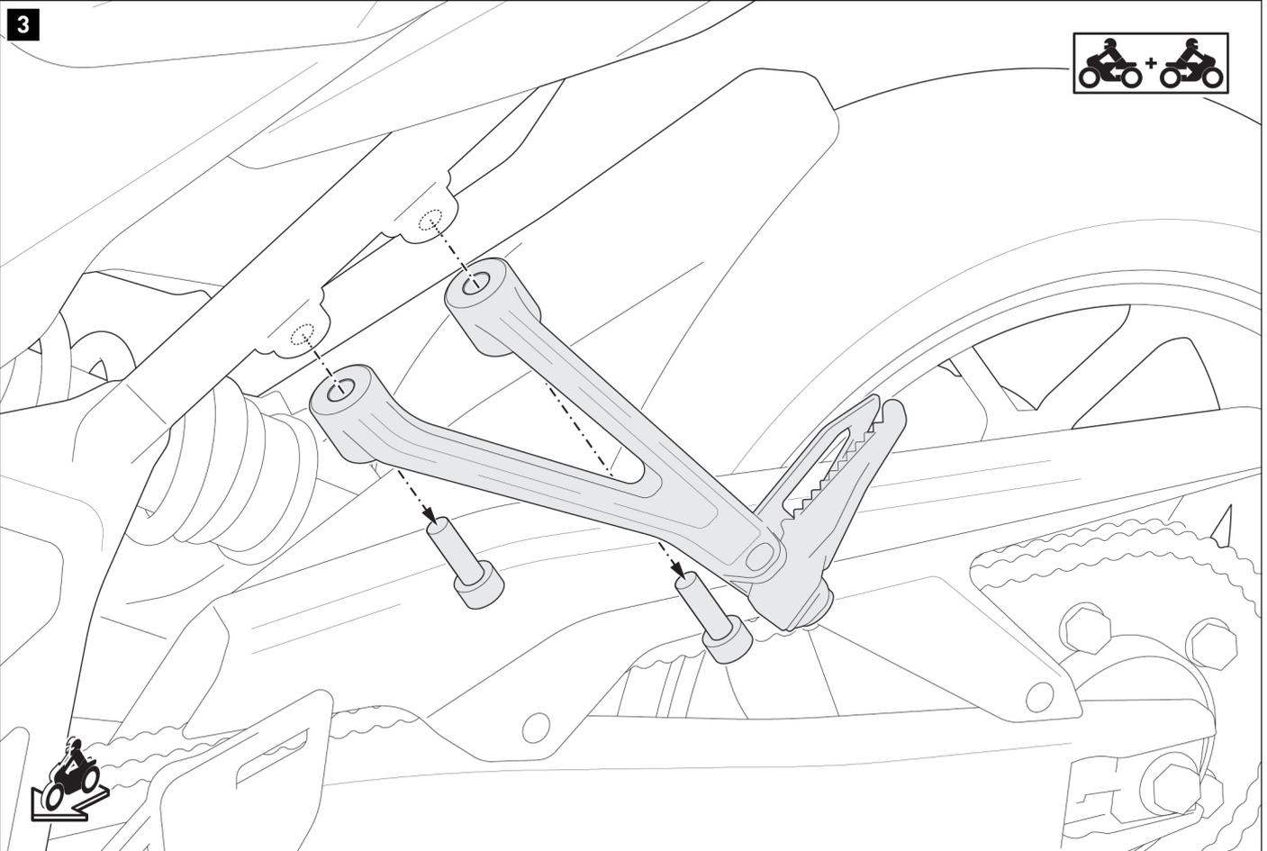
Entfernen Sie die gezeigten original Schrauben vom Fahrzeug.
