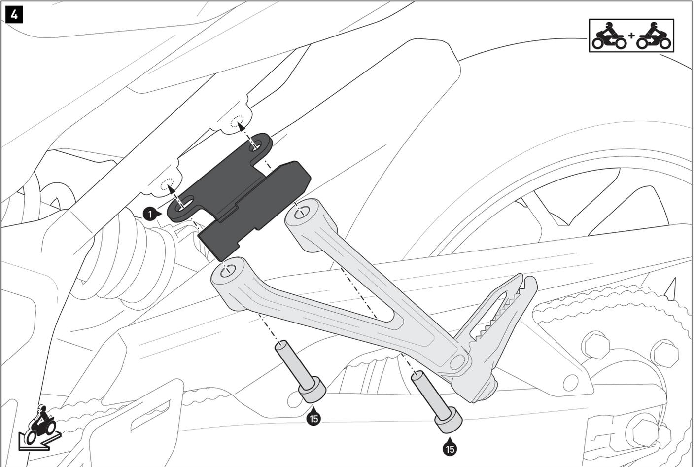
Verschrauben Sie die Anbaubleche (1/2) mit den Soziusfußrasten-Haltern am Fahrzeug.
