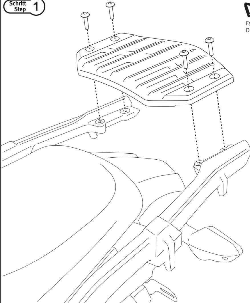
Lösen Sie die gezeigten Schrauben und entfernen Sie den originalen Gepäckträger.
