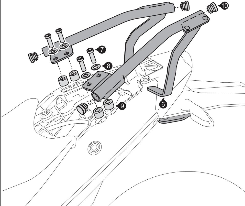
Verschrauben Sie die Rohrstreben (6) am Fahrzeug, wie in der Zeichnung gezeigt.
