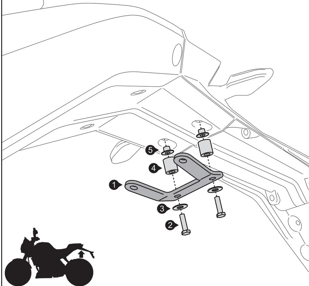
Entfernen Sie die originalen Schrauben von den Anbaupunkten. Verschrauben Sie anschließend den Querverbinder (1) am Fahrzeug, wie in der Zeichnung gezeigt.
