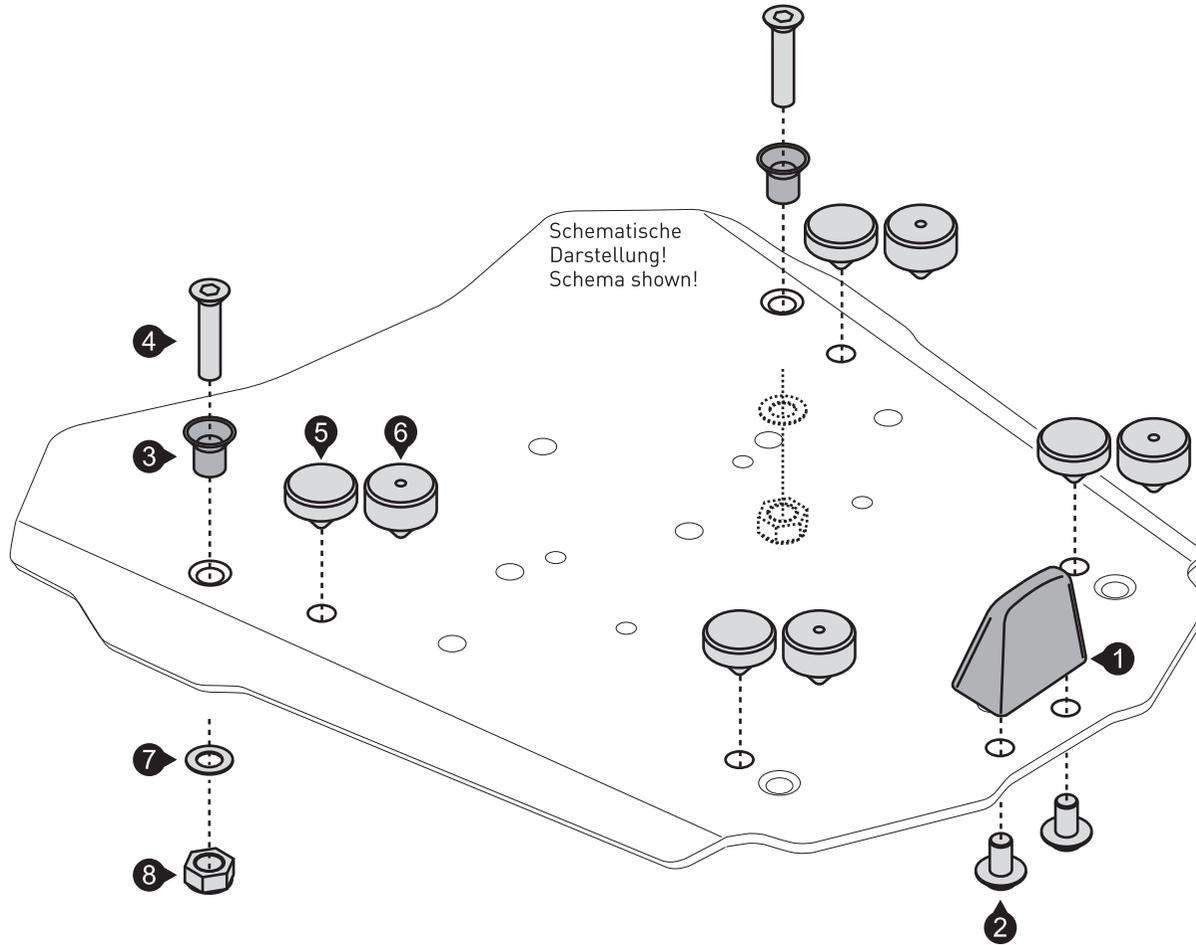
**ACHTUNG:** Bitte überprüfen Sie nach Montage der Adapterplatte an Ihrem Koffer das Spiel zwischen beiden Komponenten. Sollte zu viel Spiel vorhanden sein, ersetzen Sie die Vibrationsdämpfer (5) durch die Vibrationsdämpfer (6).
