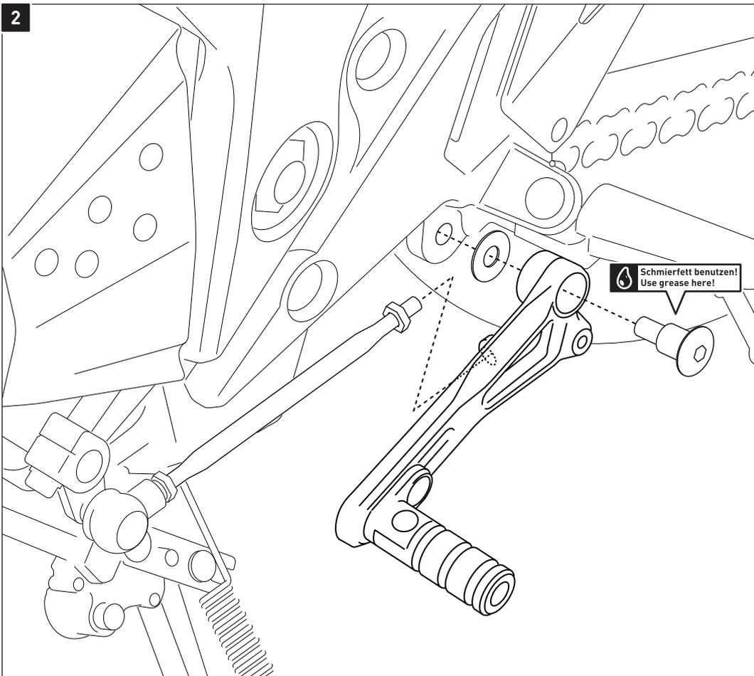
Lösen Sie die Schraube und Umlenkstange vom originalen Schalthebel und entfernen Sie diesen vom Fahrzeug.
