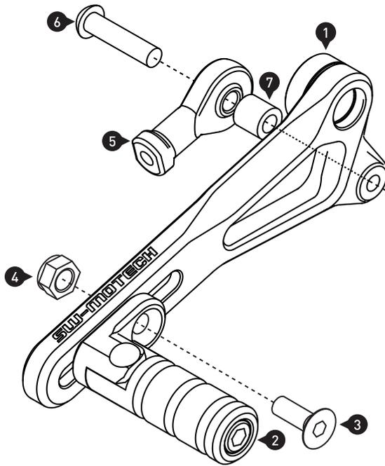
Verschrauben Sie die gezeigten Teile am Schalthebel (1), wie in der Zeichnung dargestellt. Ziehen Sie die Schraube (3) noch nicht an.
