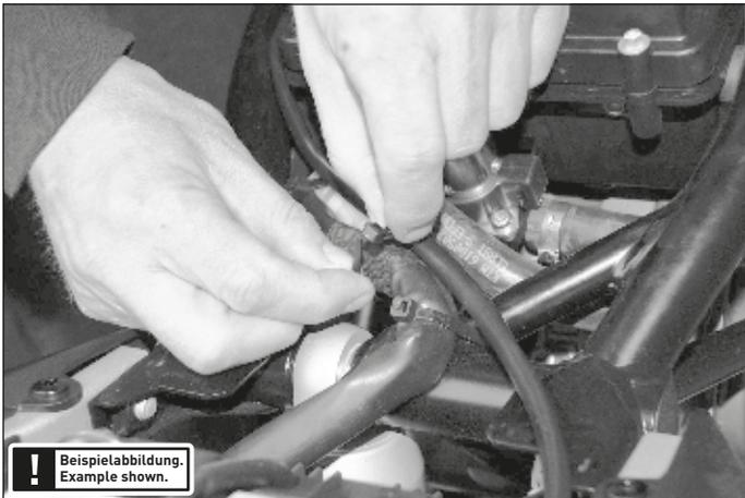
**3** Befestigen Sie den Kabelbaum mit Kabelbindern am Kabelbaum des Fahrzeugs.
